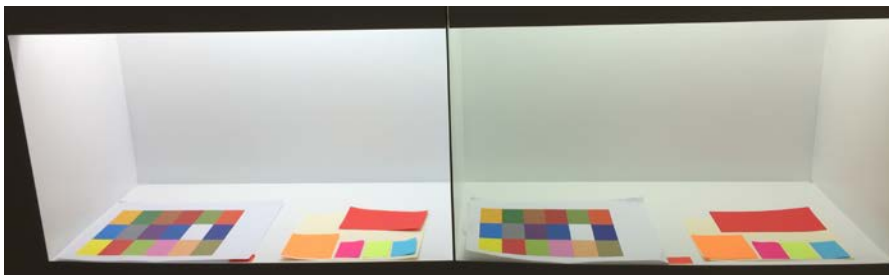
Figur 8. Exempel på färgåtergivning. Till vänster R_a -index 90 och till höger R_a -index 80.
