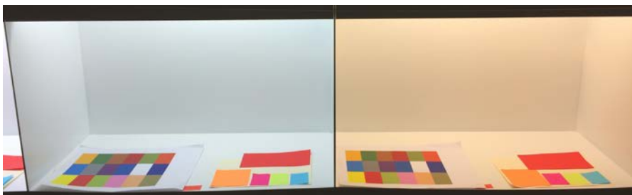
Figur 9. Exempel på färgtemperaturer. Till vänster återges färgtemperatur 4 000 K och till höger 2 700 K.
